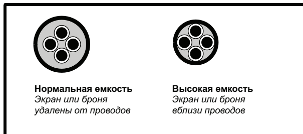
Рис. 4-17 Конструкция кабеля влияет на его емкость
