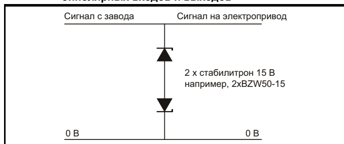
Рис. 4-43 Подавление выбросов для аналоговых и биполярных входов и выходов
