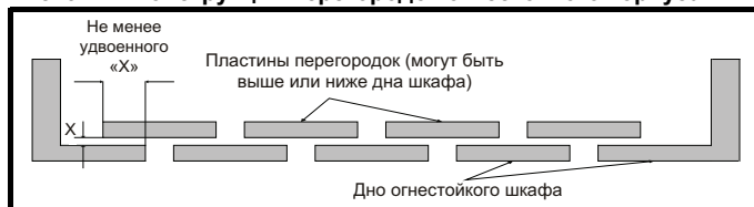
Рис. 3-2 Конструкция перегородок огнестойкого корпуса
