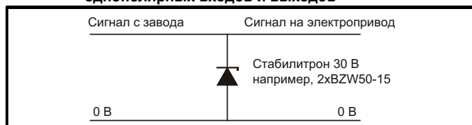
Рис. 4-43 Подавление выбросов для аналоговых и биполярных входов и выходов
